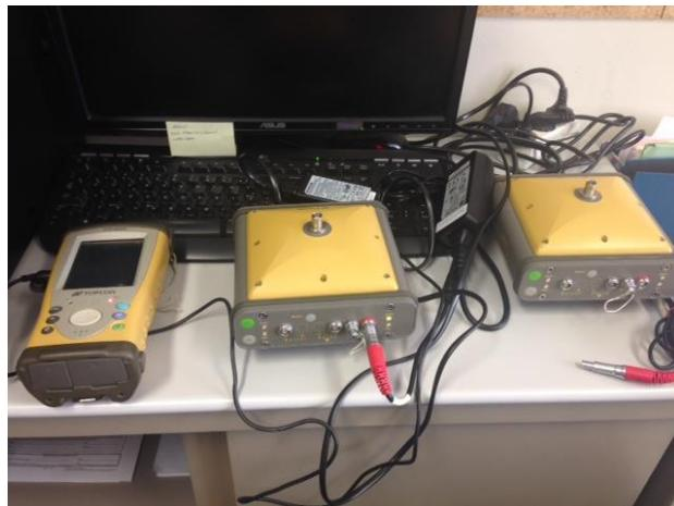
**Figura 2. Recetores GPS (BASE e ROVER) e controlador**
