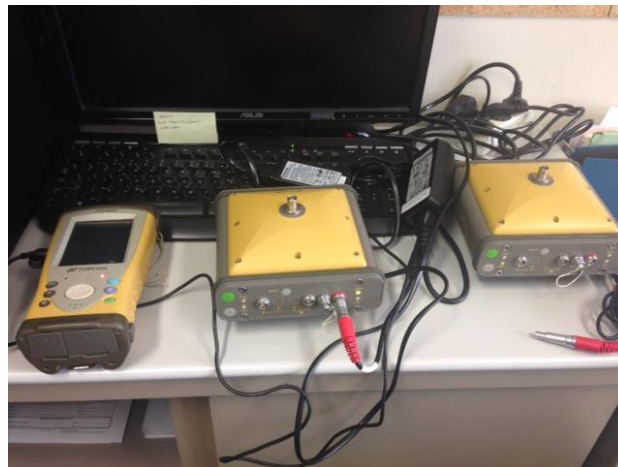
Figura 4 - Recetores GPS (BASE e ROVER) e controlador
